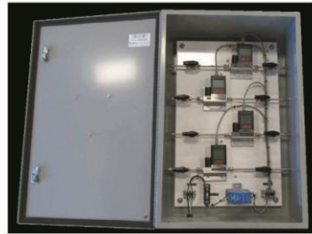
气体混合输送系统，包括质量流量计，数字控制系统，可选流体分头
